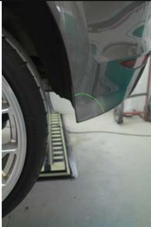
Kleine krassen in kunststof kunnen plaatselijk worden gerepareerd.
